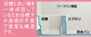
浴槽と洗い場を一体成型しているため浴槽下の清掃が不要で清潔な構造です。
